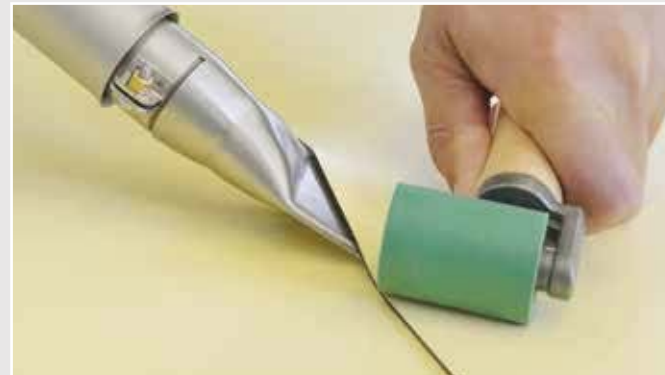
オーバーラップ溶接
